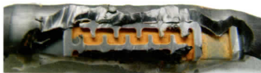
Fot. 1. Osad związków żelaza w labiryncie kropłownika
