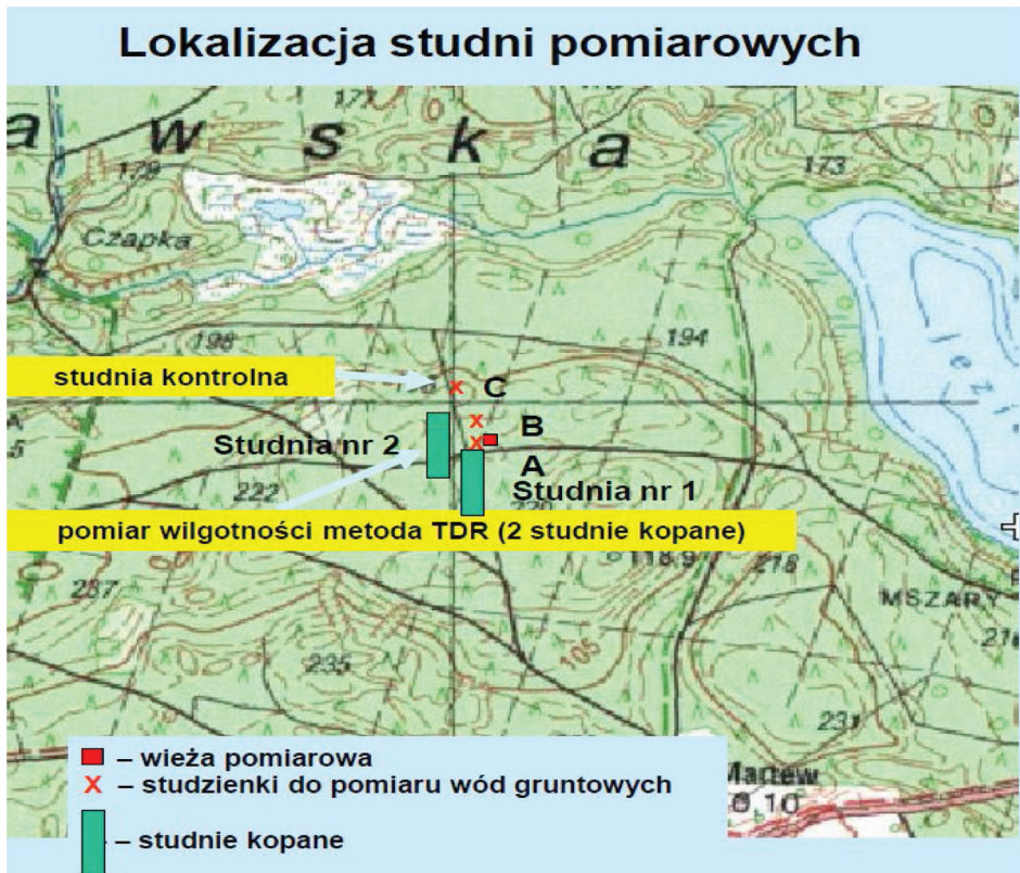
Rysunek 1. Rozmieszczenie urządzeń pomiarowych w zakresie badań hydrologicznych Figure 1. Location of measuring instruments related of hydrological investigations
