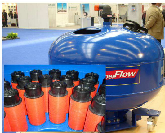
Fot. 24. Zestaw filtracyjny „Super Flow” w obudowie filtra piaskowego zamiast złoża piasku umieszczono dyski filtracyjne
