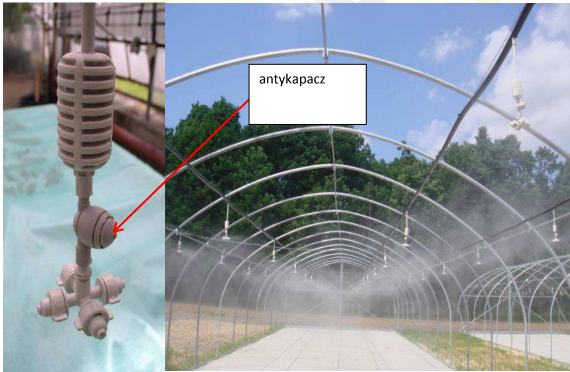
Fot. 8. Minizraszacz CoolNet służący do podnoszenia wilgotności powietrza i schładzania roślin
