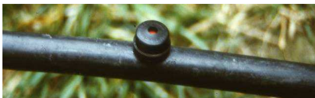
Fot. 14. Kroplownik montowany na przewodzie polietylenowym
