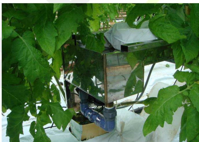
Fot. 35. Waga sterująca nawadnianiem wraz z kontrolą ilości i zasolenia drenażu
