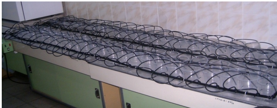
Fot. 1. Instalacja do testowania wydanku emiterów (fot. autor)
