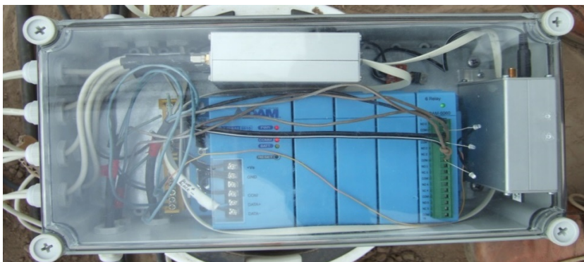
Fot. 5. TDR, MIDL i sterownik PLC (fot. autor)
