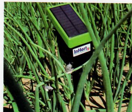
Fot.1. Bezprzewodowa sonda AM-100 na plantacji cebuli
