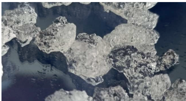
Fot. 6. Uwodnione kryształki hydrożelu. (W. Treder)
