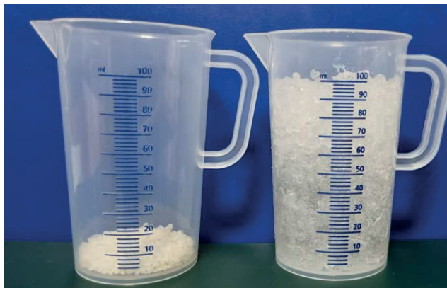
Fot. 7. Jeden gram prezentowanego hydrożelu pochłonął 80 gramów wody wodociągowej. (W. Treder)
