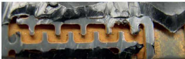
Fot. 20. Osady związków żelaza w labiryncie emitera kropłowego. (W. Treder)
