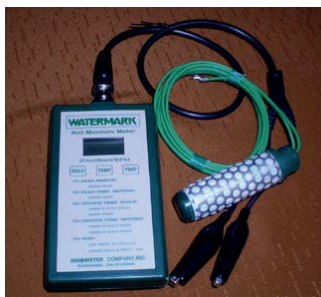
Fot. 71. Miernik potencjału wodnego gleby wraz z czujnikiem opornościowym. (W. Treder)
