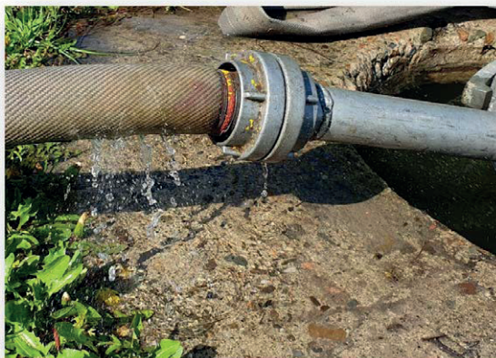
Fot. 66. Taki „niewinny” przeciek w skali sezonu jest przyczyną bardzo dużych strat wody. (W. Treder)
