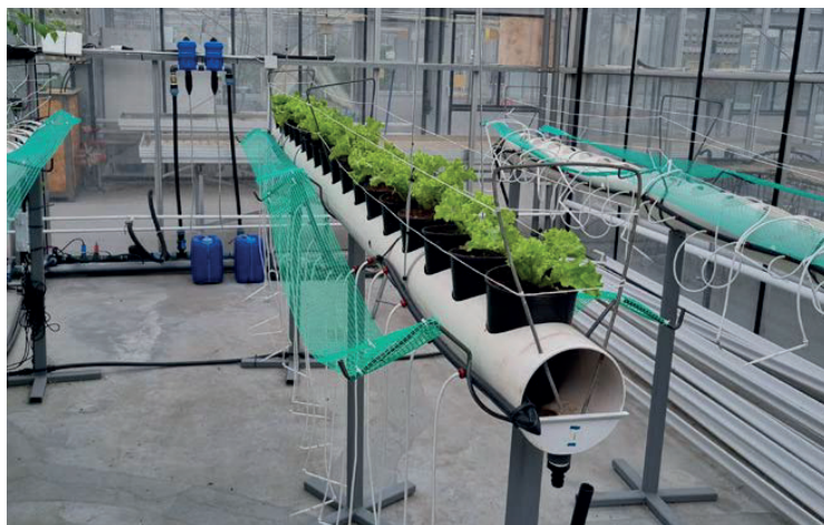
Fot. 79. Platforma wagowa do sterowania nawadnianiem. (W. Treder)
