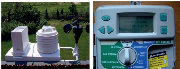
Fot. 77. Sterownik współpracujący ze stacją meteo wyznaczającą ewapotranspirację. (W. Tredler)
