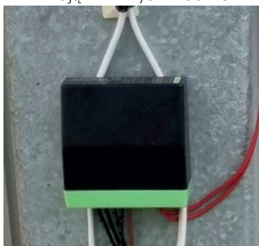
Fot. 78. Bezprzewodowy sterownik nawadniania. (W. Treder)
