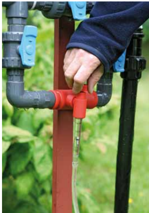
Fot. 4. Injektor, w którym ilość zasysanej pożywki można regulować przez wymianę restryktorów
